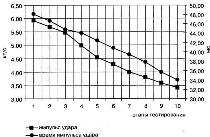
Рис. 14. Показатели импульса и времени импульса удара в ходе скоростной нагрузки
